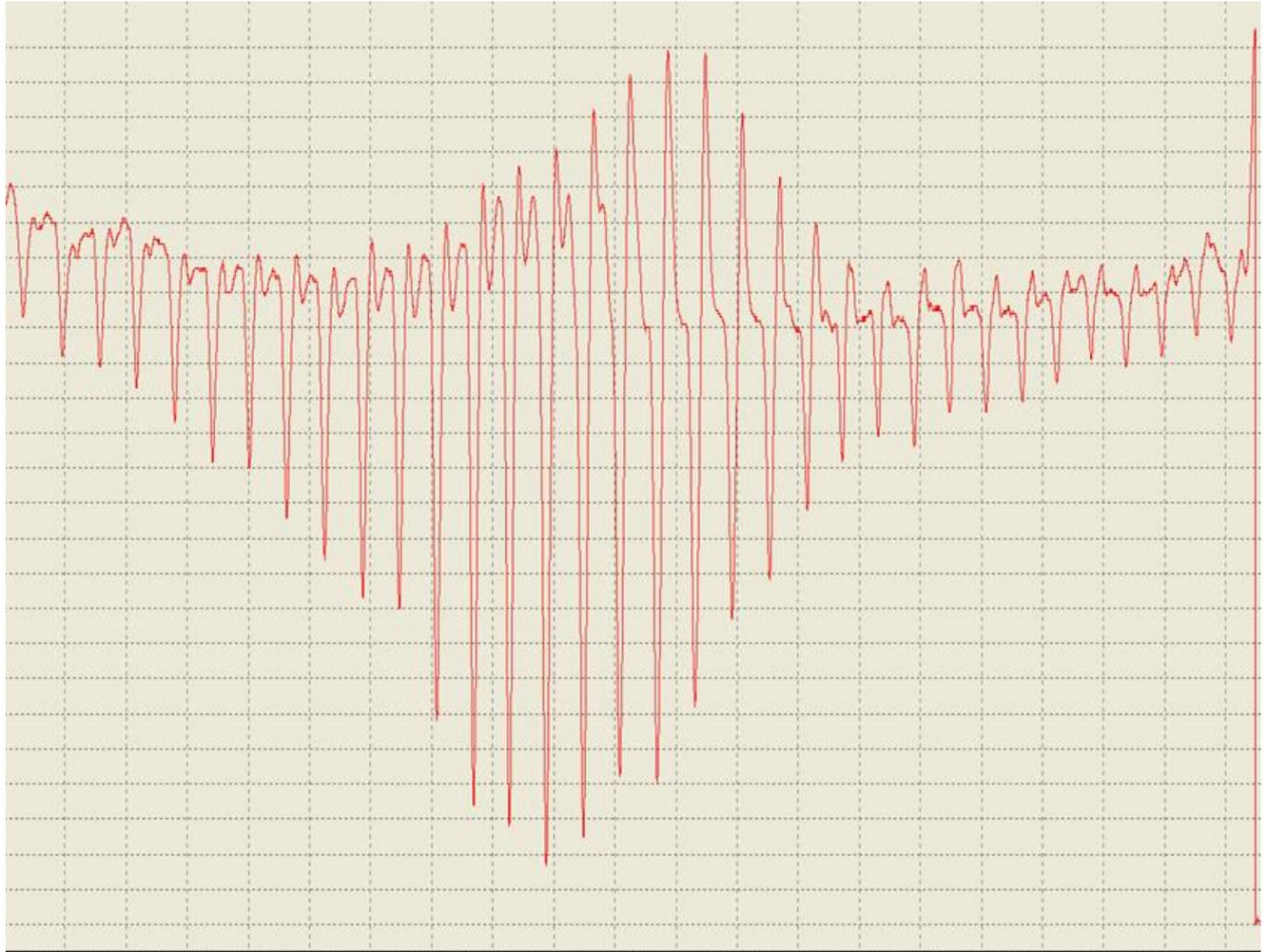
图 1 震荡法的 ADC 脉搏曲线信号
