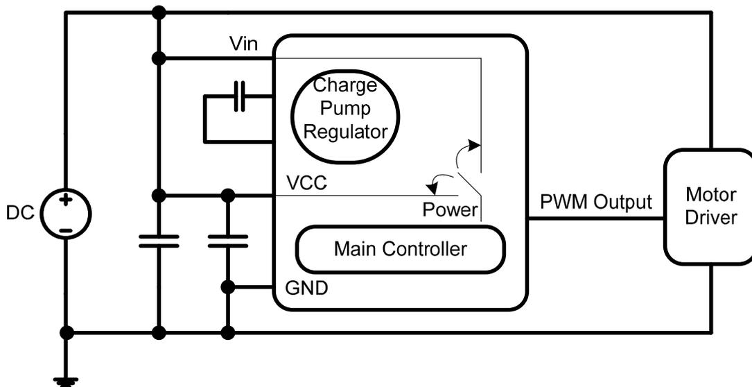
图 2 HY16F188 内部电源架构
