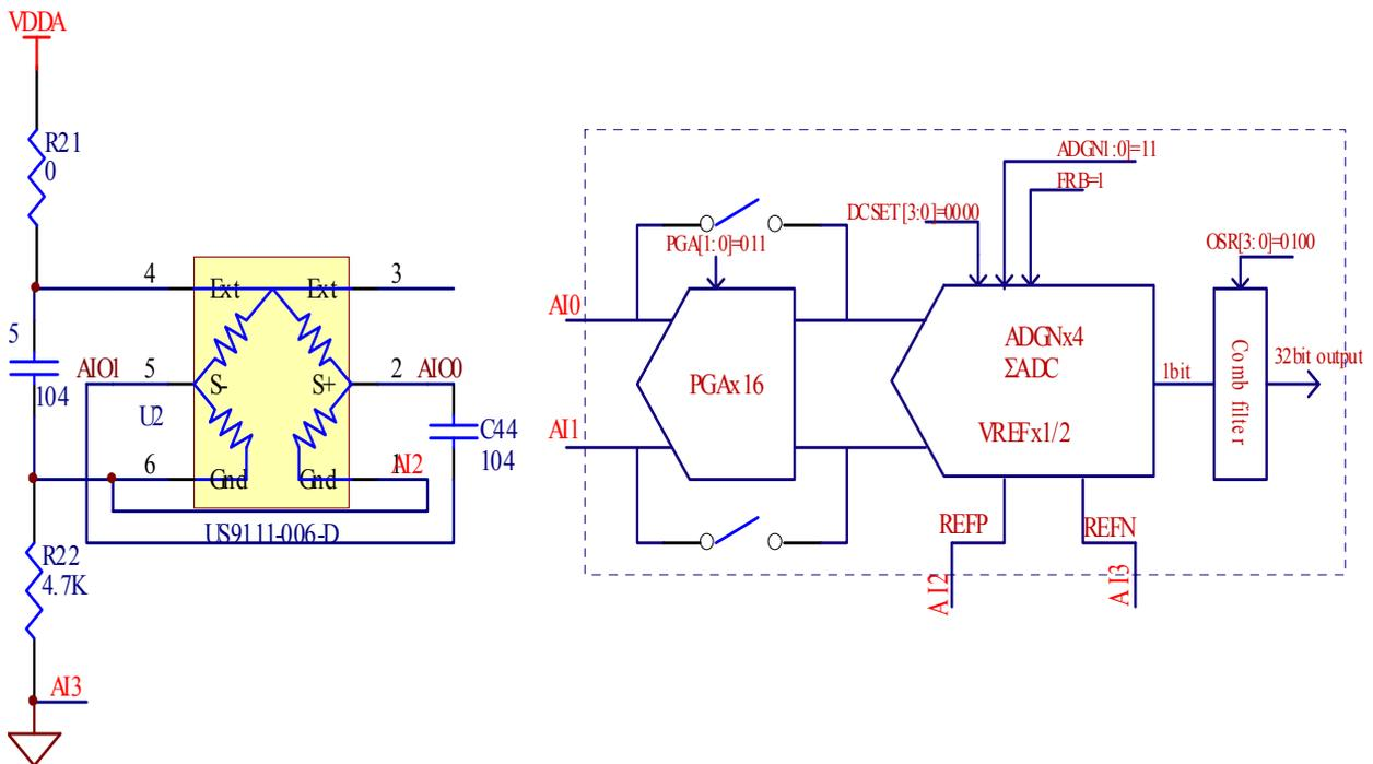
图 2 血压信号量测电路
